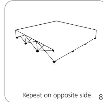
ATTACH STABILIZER FEET TO FRAMES 3 QUADS HIGH
